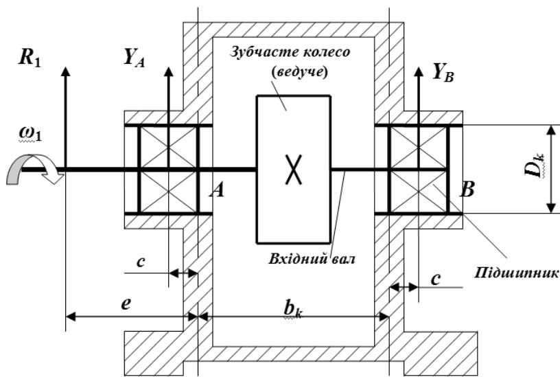
Рис. 2. Поперечний переріз корпуса редуктора та схема його навантаження
